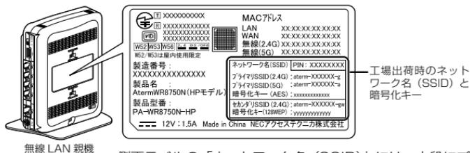
側面ラベルの「ネットワーク名 (SSID)」には、上段にプライマリ SSID、下段にセカンダリ SSID の無線設定内容 (2.4GHz・5GHz 別の SSID、暗号化モード、暗号化キー) が表示されています。(セカンダリ SSID の 5GHz の SSID は、末尾 2 桁が「aw」になります。) なお、暗号化キーは、プライマリ SSID・セカンダリ SSID ごとに異なります。
