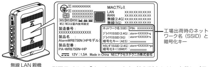
側面ラベルの「ネットワーク名 (SSID)」には、上段にプライマリ SSID、下段にセカンダリ SSID の無線設定内容 (2.4GHz・5GHz 別) の SSID、暗号化モード、暗号化キー) が表示されています。(セカンダリ SSID の 5GHz の SSID は、末尾 2 桁が「aw」になります。) なお、暗号化キーは、プライマリ SSID・セカンダリ SSID ごとに異なります。
