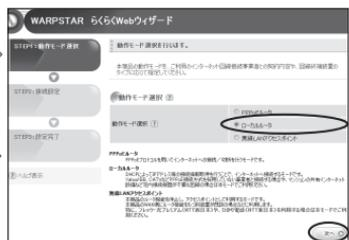
(※3) IP電話をご利用で、ルータ機能が内蔵されているIP電話対応機器に接続の場合は、無線LANアクセスポイントモードをお勧めします。
