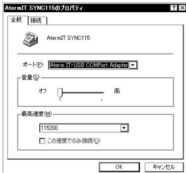
注: AtermIT MP128でCOMポートに接続する場合は、速度を[115200]としてください。COMポートで230400の速度を出すには、高速シリアルボードが別途必要になります。
