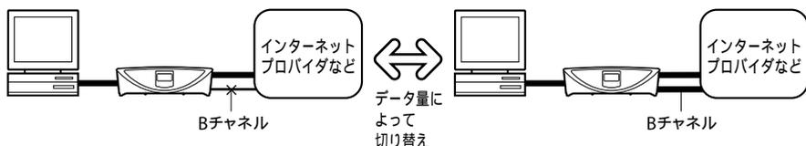
設定した「リンク追加算出時間」内の送出、または受信データ量が「リンク追加しきい値」より大きくなれば、2つ目のBチャンネルを追加して、2つのBチャンネルを同時に使用します。また、設定した「リンク削除算出時間」内の送出、または受信データ量が「リンク削除しきい値」より小さくなれば、2つ目のBチャンネルを削除して、1つのBチャンネルのみを使用するようにします。
