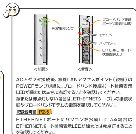
ACアダプタ接続後、無線LANアクセスポイント(親機)のPOWERランプが緑に、ブロードバンド接続ポート状態表示LEDが緑または赤色に点灯することを確認してください。緑または赤色に点灯しない場合は、ETHERNETケーブルの接続状態やブロードバンドモデムの電源を確認してください。
