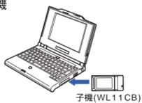
子機を取り付けるパソコンのカードスロットに子機を取り付けます。コネクタの向きに注意して、しっかりと奥まで差し込んでください。
