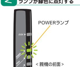
ブロードバンド接続ポート状態表示LEDが緑色に点灯することを確認してください。緑色に点灯しない場合は、ETHERNETケーブルの接続状態やブロードバンドモデムの電源を確認してください。取扱説明書 P2-5
