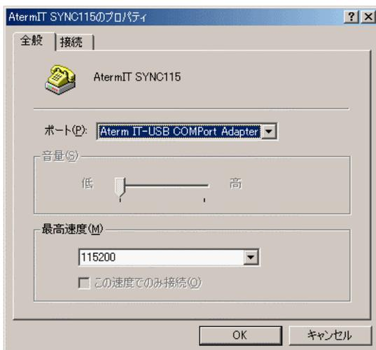
注：AtermIT MP128 で COM ポートに接続する場合は、速度を [115200] としてください。COM ポートで 230400 の速度を出すには、高速シリアルボードが必要です。
