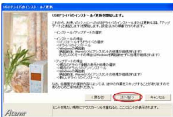
5. 「USB ドライバを新たにインストールする」と「Aterm モード」用ドライバをインストールする」を選択し、[ 次へ ] をクリックする。
