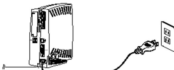
( 2 ) ADSLモデムとWARPSTARのプロードバンド接続ポートを接続します。
