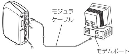
外付けモデムの場合：Atermのアナログポートとモデムをモジュラケーブルで接続し、モデムとパソコンのCOMポートをRS-232Cケーブルで接続します。
